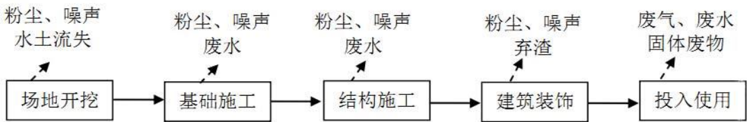
图 5-1 项目施工期流程和产污节点图
