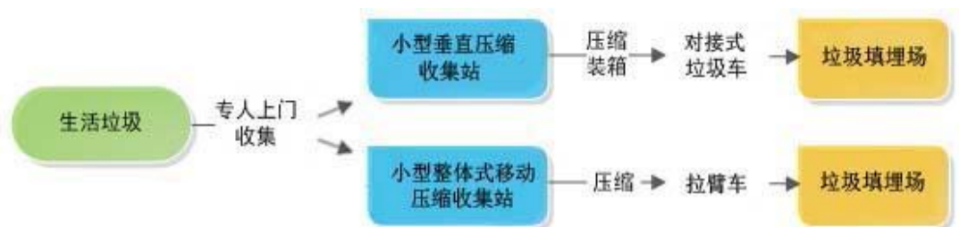
图 5-3 “收集点+小型压缩式收集站” 流程
