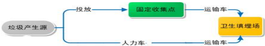
图 5-2 “后装式垃圾车直运” 流程
